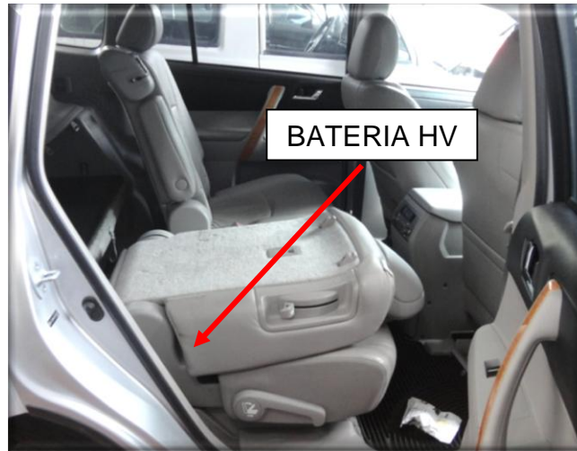
Ilustración 59: Ubicación de la batería alta tensión Toyota Highlander.
