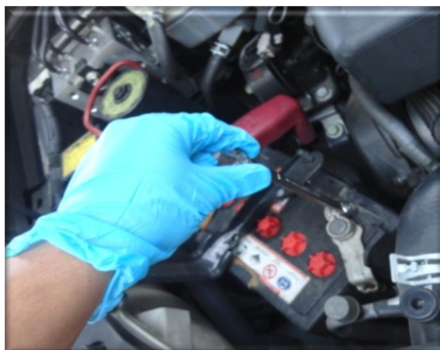
Ilustración 58: Desconexión de la batería auxiliar de doce voltios.
