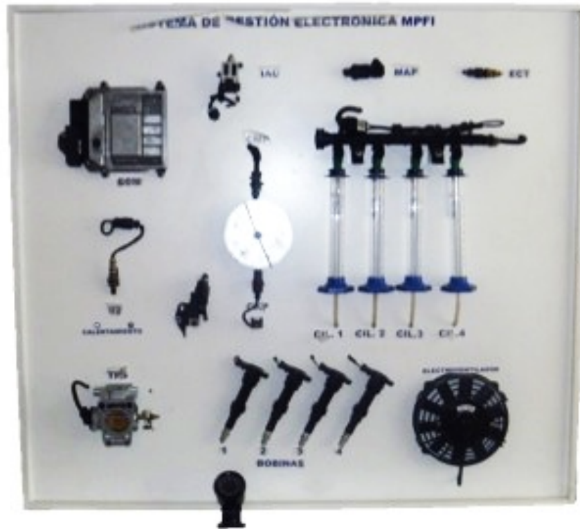
Figura 39. Sistema de inyección ubicado en el módulo. (Serrano, 2013)
