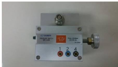
Figura 102. Fotografía switch de presión
