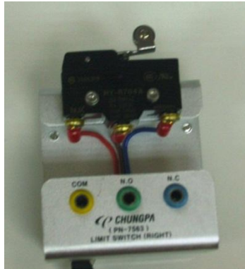
Figura 134. Fotografía switch limitador eléctrico derecho
