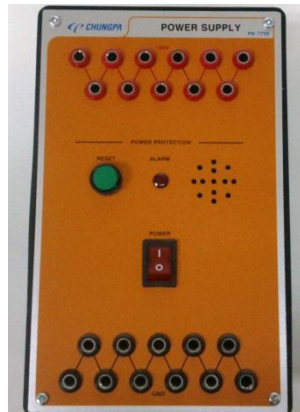
Figura 124. Fotografía fuente de poder
