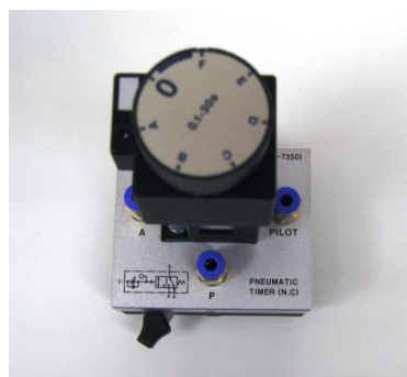
Figura 36. Fotografía temporizador neumático
