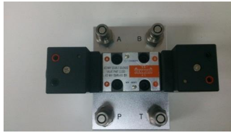
Figura 120. Fotografía valvulas solenoide 4/3 vías ambos lados
