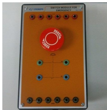
Figura 62. Fotografía módulo switch de emergencia
