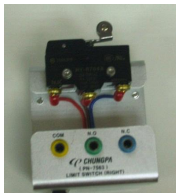
Figura 67. Fotografía switch limitador eléctrico en posición derecha
