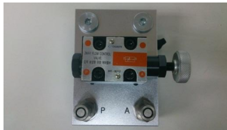
Figura 97. Fotografía válvula controladora de flujo
