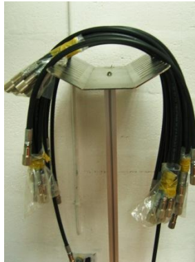
Figura 141. Fotografía soporte de mangueras hidráulicas (tipo stand)
