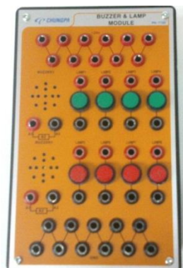
Figura 64. Fotografía módulo de buzzer y lamp
