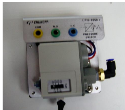
Figura 69. Fotografía convertidor de señal eléctrica
