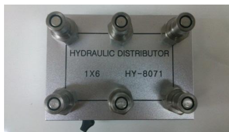
Figura 85. Fotografía distribuidor hidráulico B
