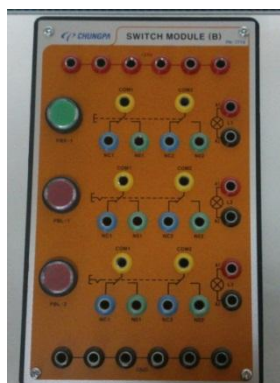
Figura 129. Fotografía módulo switch (B)
