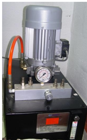
Figura 137. Fotografía bomba hidráulica
