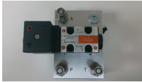
Figura 114. Fotografía válvula solenoide 3/2 vías NA retorno por resorte
