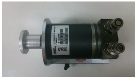
Figura 83. Fotografía motor hidráulico
