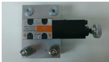
Figura 93. Fotografía válvula reguladora de presión.
