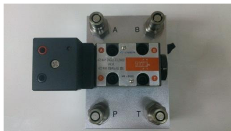
Figura 116. Fotografía válvula solenoide 4/2 vías retorno por resorte
