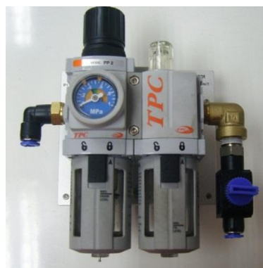
Figura 75. Fotografía de la unidad de mantenimiento.
