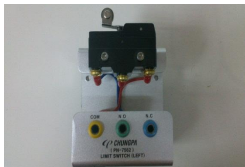
Figura 133. Fotografía switch limitador izquierdo
