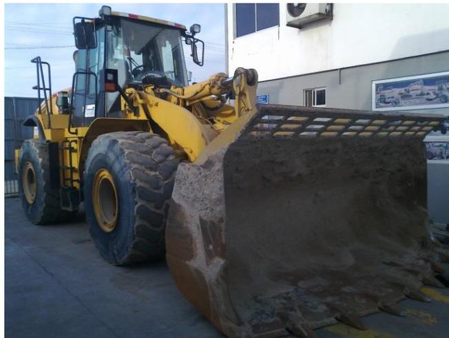
**Figura 19.** Cargadora frontal Cat 966H
