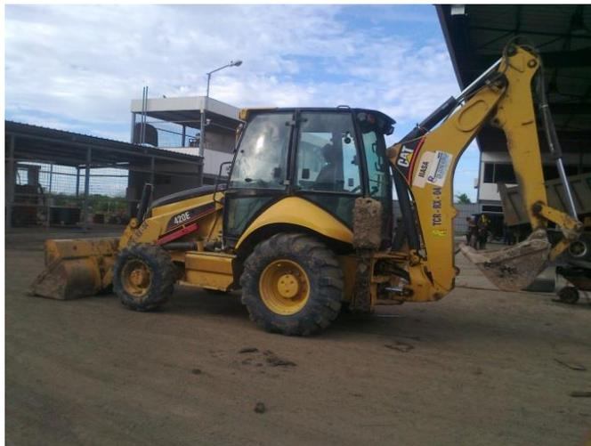
**Figura 29.** Retroexcavadora Cat 416E
