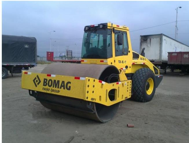
**Figura 28.** Rodillo compactador Bomag BW219DH4
