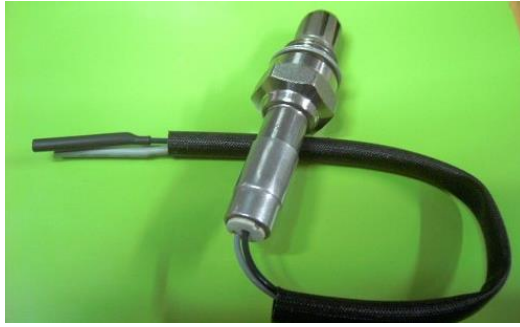
Figura 16. Sensor de Oxígeno de zirconio
