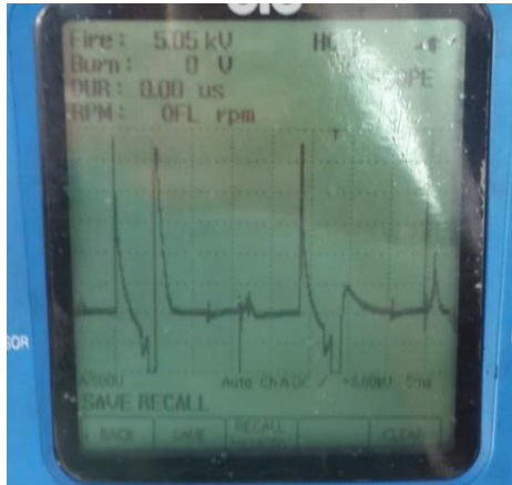
Figura 28. Oscilograma del secundario de la bobina DIS
