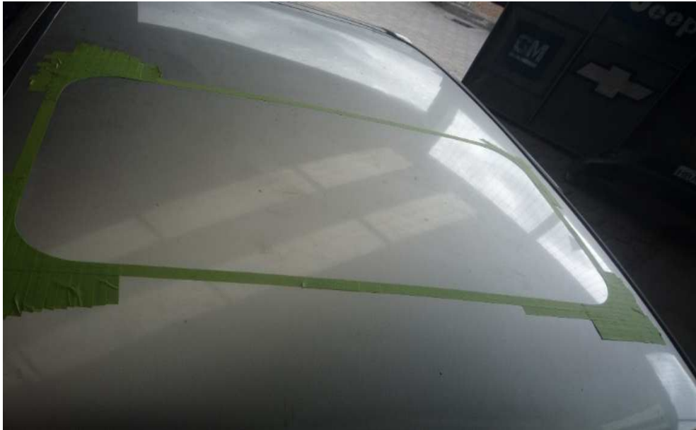
Figura 42. Paso del molde al techo.
