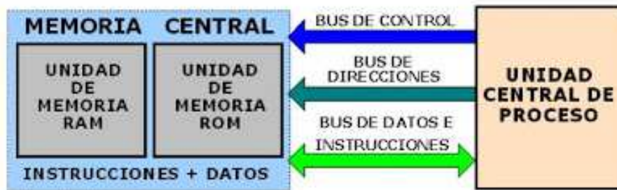
Figura 7. Diagrama arquitectura von neumann
