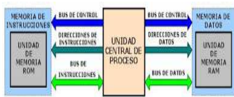
Figura 8. Diagrama arquitectura Harvard
