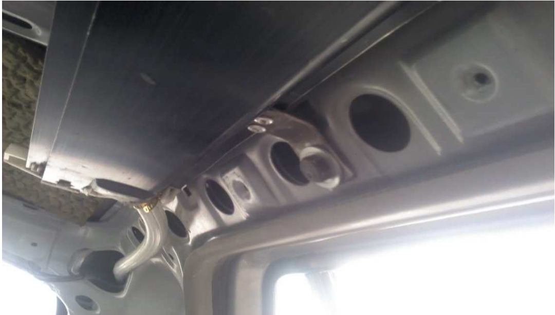
Figura 46. Sujeción del sunroof.
