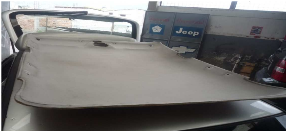
Figura 36. Extracción de la tapicería
