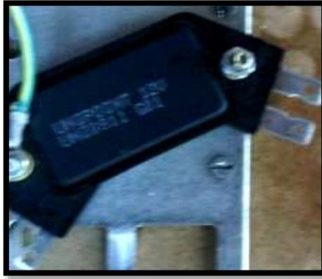
**Figura 46** Modulo de Encendido genérico
