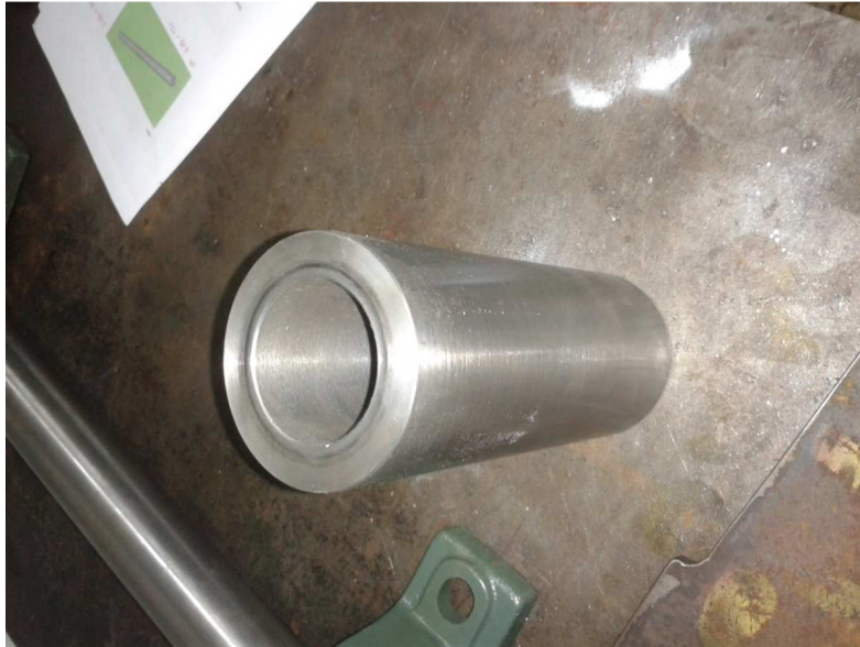
Figura 100. Eje de base de ballesta
