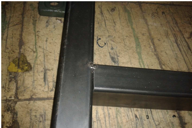
Figura 95. Soldadura en unión entre tubos rectangulares
