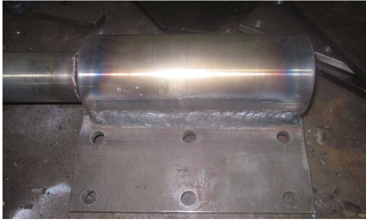
Figura 101. Base de ballesta terminada y soldada a eje base
