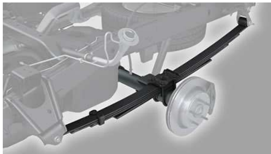
Figura 36. Ballesta y eje posterior (MEGANEBOY3, 2011)
