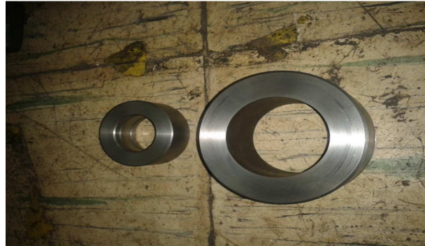
Figura 105. Bases de excéntrica
