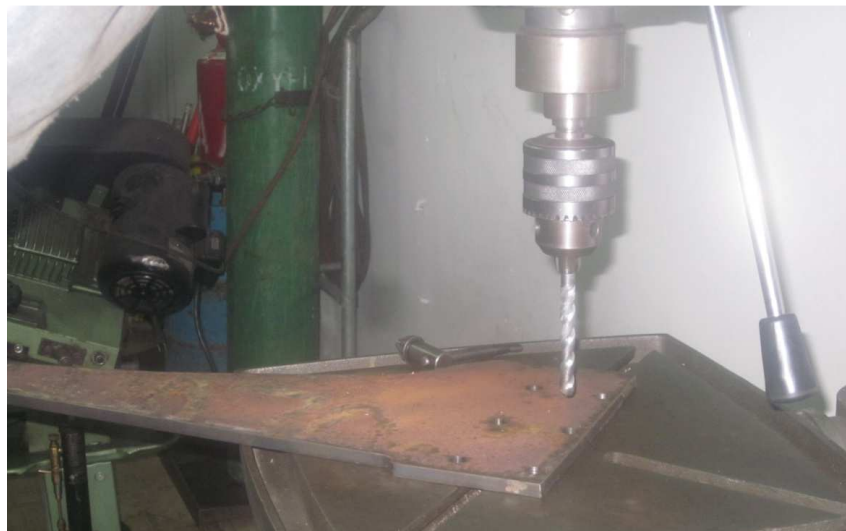
Figura 103. Perforaciones para pernos en ballesta
