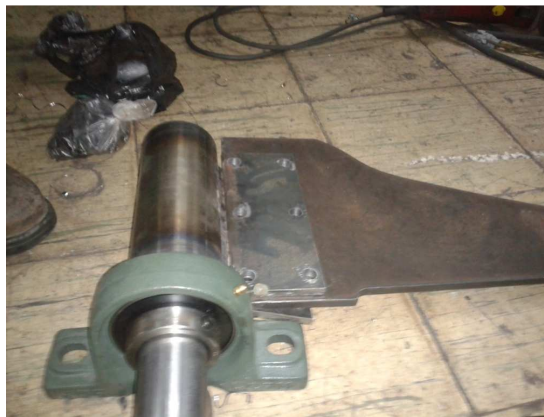
Figura 111. Unión de Ballesta con bases hacia el eje
