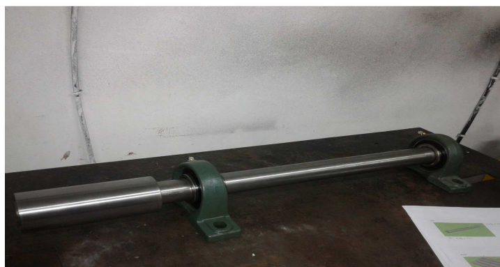
Figura 98. Eje principal, chumaceras y base de ballesta
