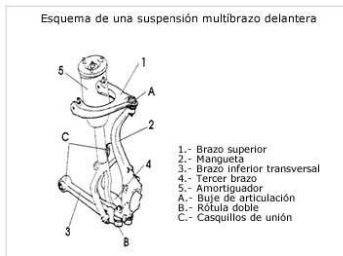
Figura 52. Suspensión multibrazo delantera
