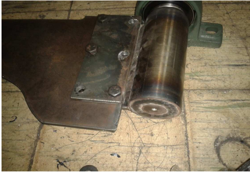
Figura 112. Fijación de ballesta hacia el eje principal
