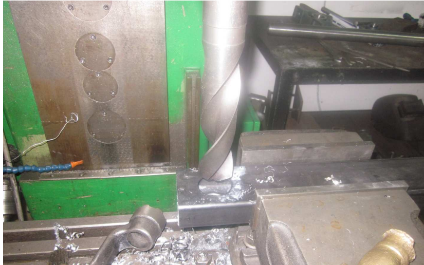
Figura 92. Perforaciones en tubos rectangulares
