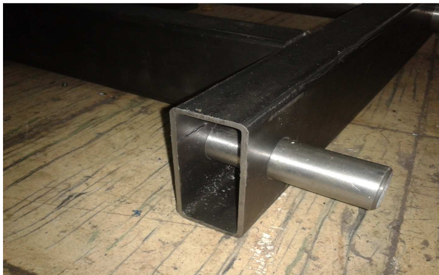
Figura 97. Eje para chumaceras de pared
