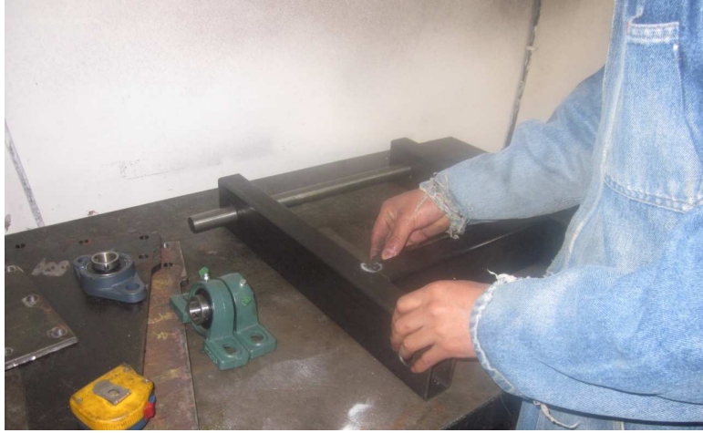
Figura 94. Unión entre tubos rectangulares y eje secundario
