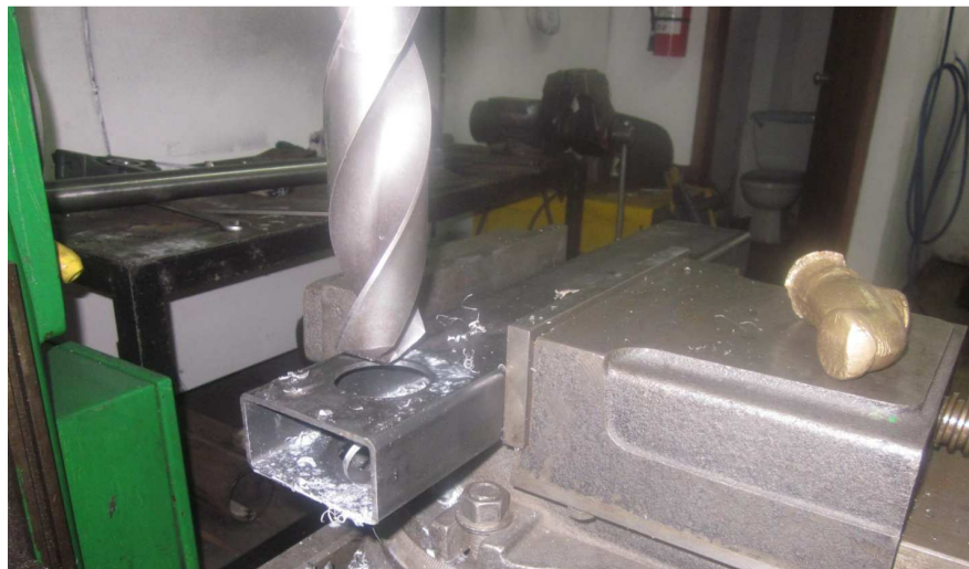
Figura 93. Perforaciones en tubos rectangulares principales
