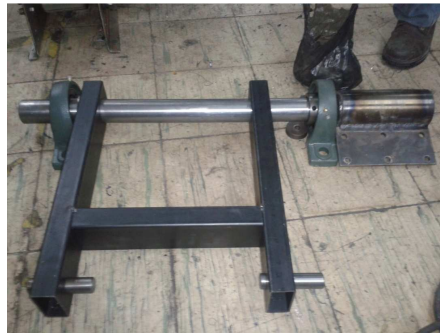
Figura 110. Unión del Tubo Rectangular, eje principal, chumaceras y base de ballesta
