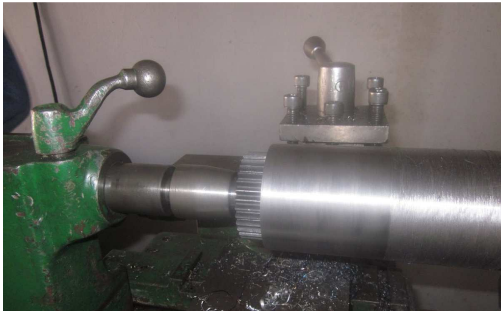
Figura 99. Refrentado y cilindrado de ejes.
