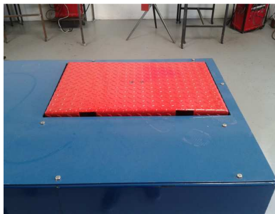
Figura 90. Plancha de asentamiento del neumático terminada
