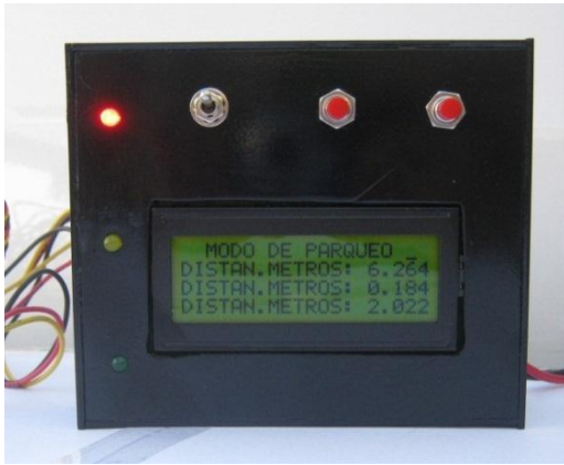
Figura 4.17 Modo de parqueo a) Lectura de los sensores de distancia sin obstáculos, b) Lectura del sensor EZ4 con distancia de frente de 0,196m, c) Lectura del sensor HC-SR04 con distancia del lado posterior izquierdo de 0,173m d) Lectura del sensor HC-SR04 con distancia del lado posterior derecho de 0,184m
