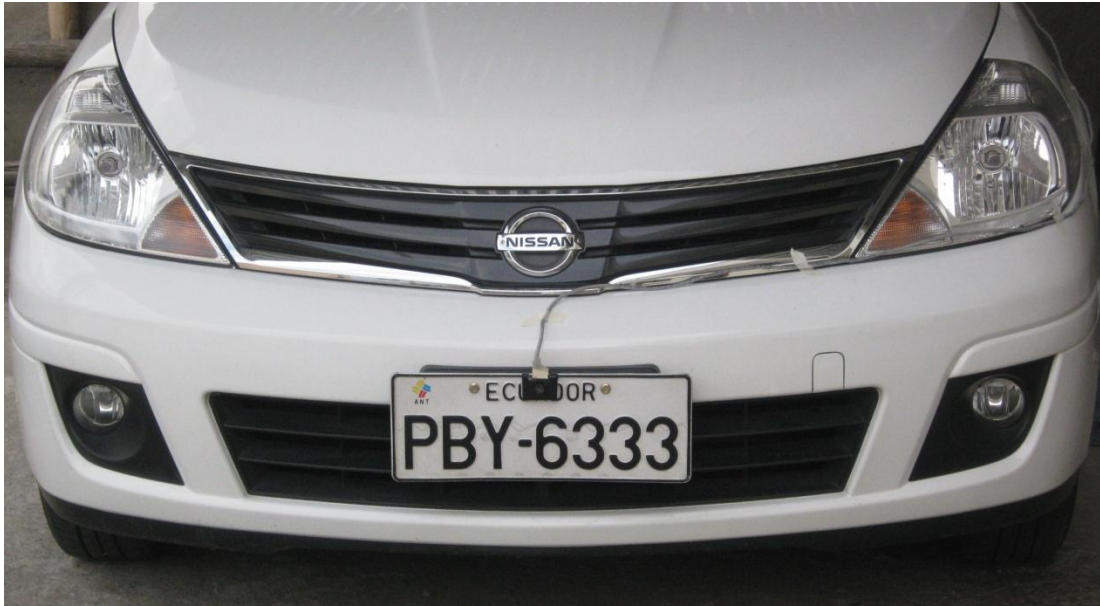
Figura 4.11 Ubicación de los sensores de distancia. Sensor EZ4
