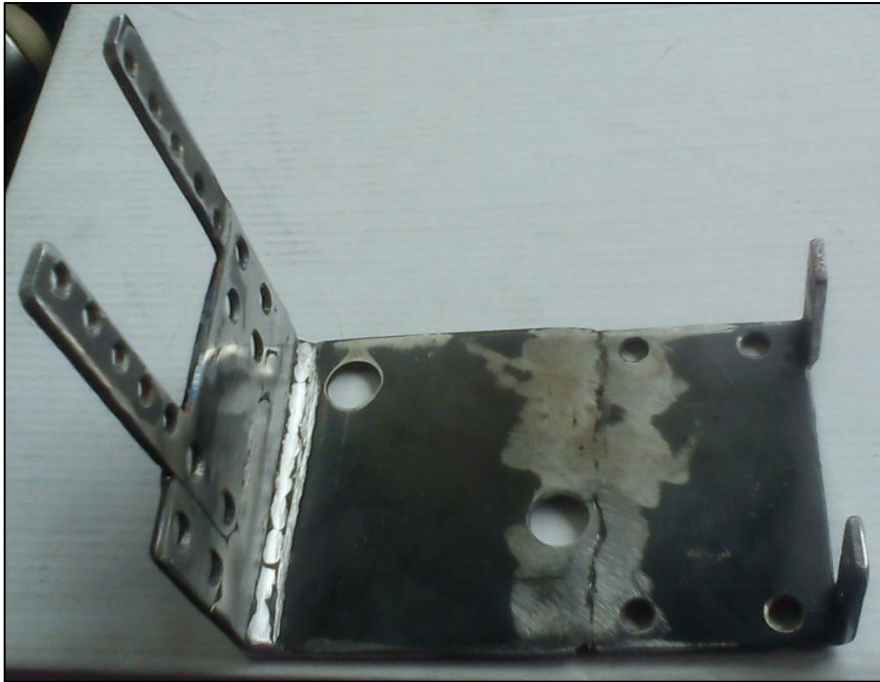
Figura 4.13 Base de los servomotores pedal de freno y del pedal del acelerador.
