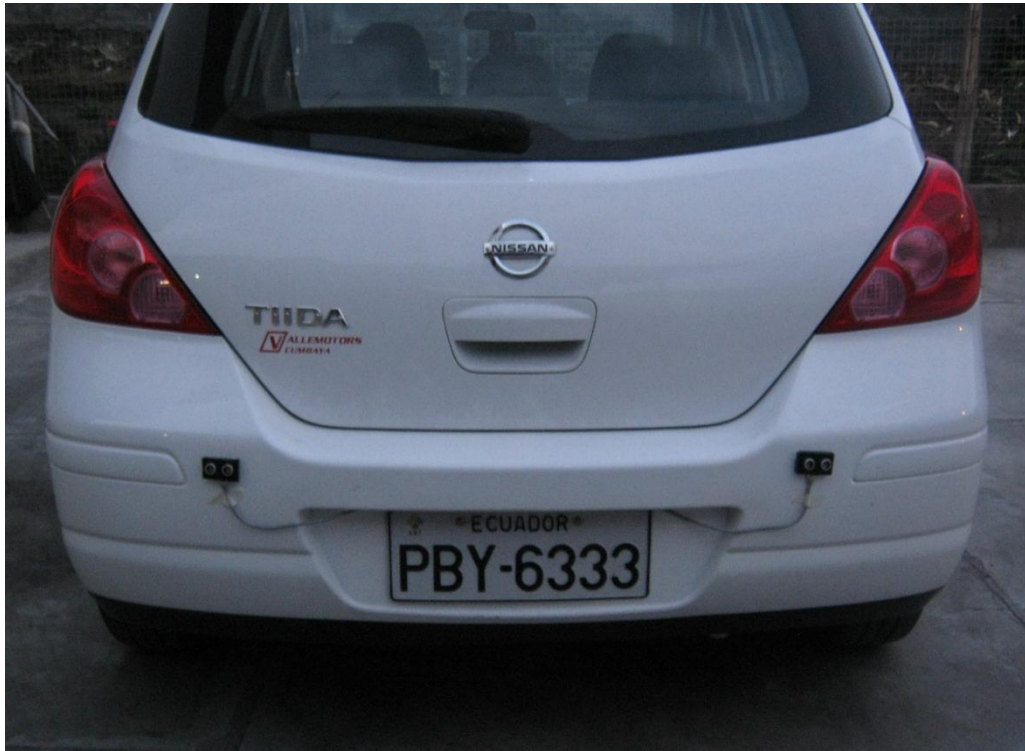
Figura 4.12 Ubicación de los sensores de distancia. Sensores HC-SR04
