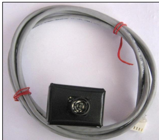
Figura 4.10 Implementación de los sensores de distancia. Sensor EZ4
