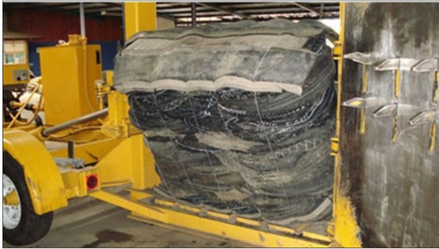
Figura 13. NFU compactados en un producto llamado “Llantón” Fundellantas
