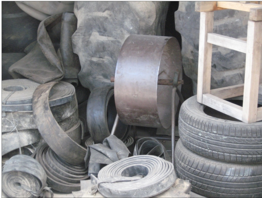
Figura 35. Herramienta artesanal usada para el corte de los laterales de los neumáticos
