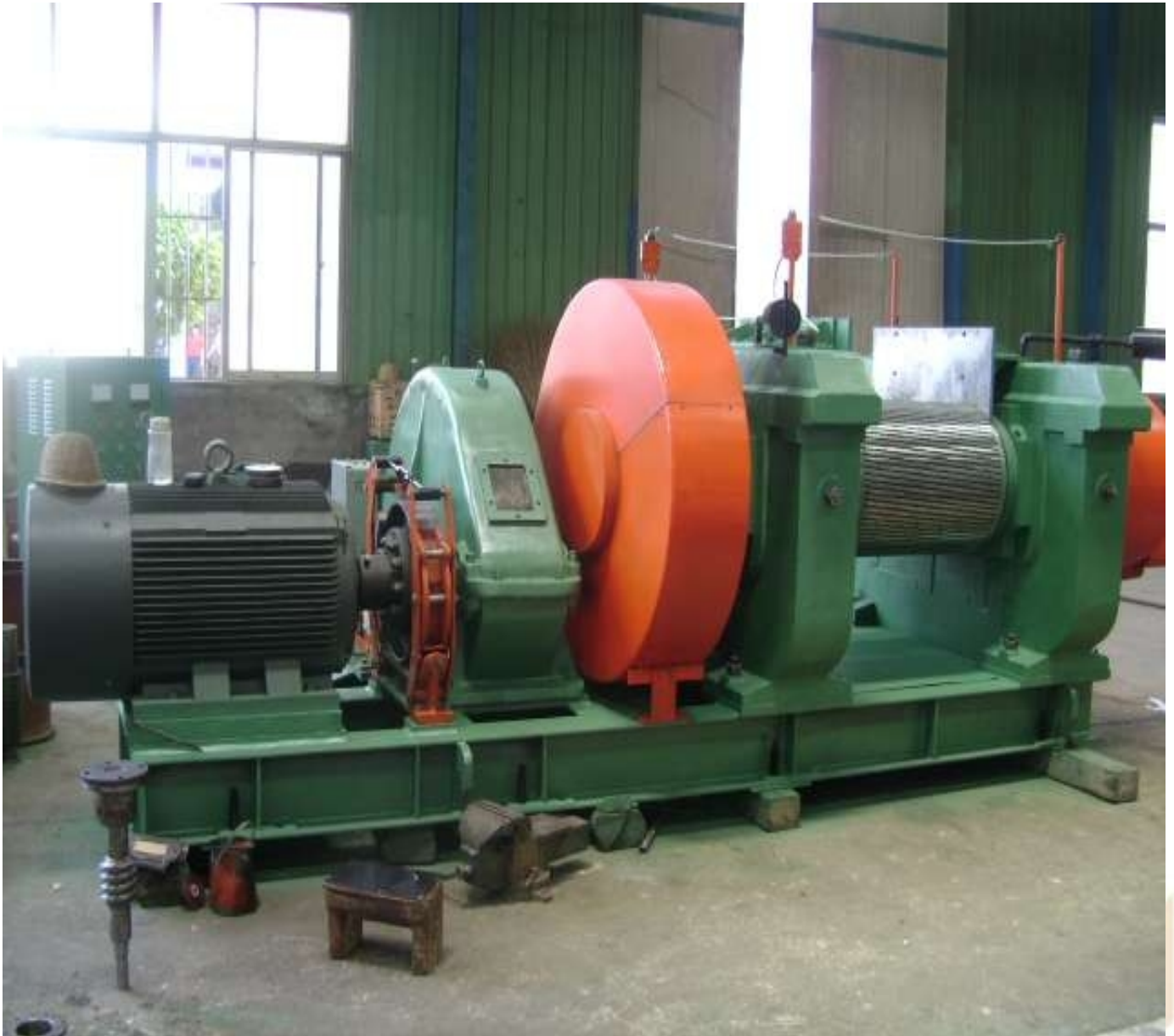
Foto tyre crusher (granuladora) produce material final de caucho entre 5 y 30 mesh
