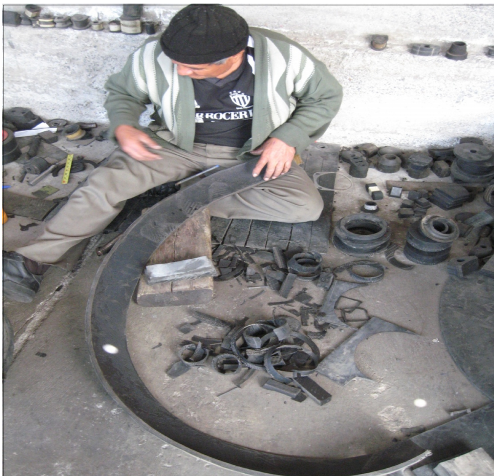
Figura 34. Corte y forma artesanal de neumáticos de desecho.
