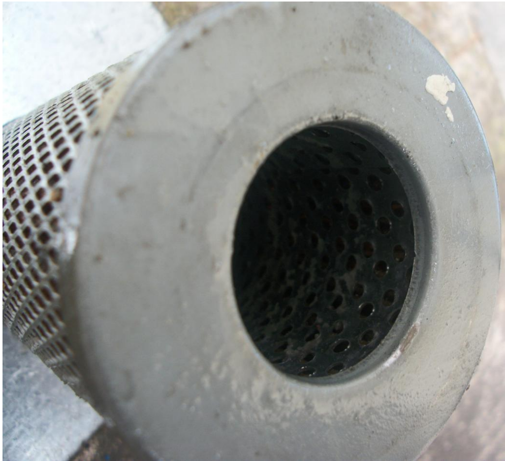
Figura: 3.28: Depósitos de almidón dentro del filtro de combustible.
