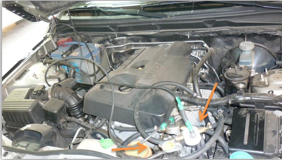
Figura A5.3 Conexión de medidores de flujo de combustible (de ingreso y retorno) en el vehículo de transmisión manual.
