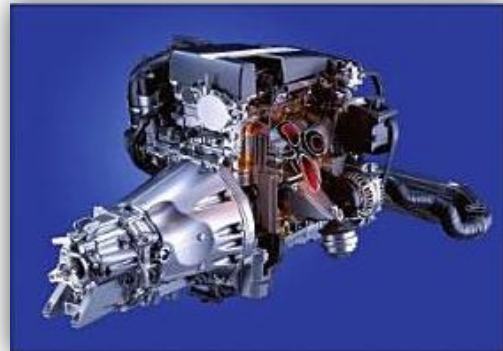
Figura 2.5 Caja de cambios para motor longitudinal
