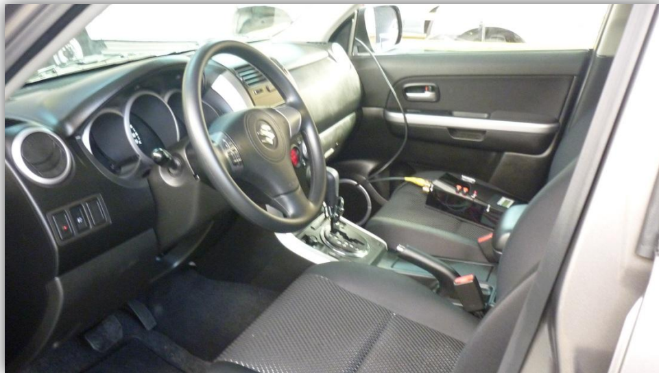
Figura A5.8 Conexión de receptor de medidor de flujo de combustible y convertidor de corriente en el vehículo de transmisión automática.
