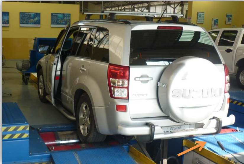
Figura A5.5 Conexión de sonda para medición de gases de escape en el vehículo de transmisión manual
