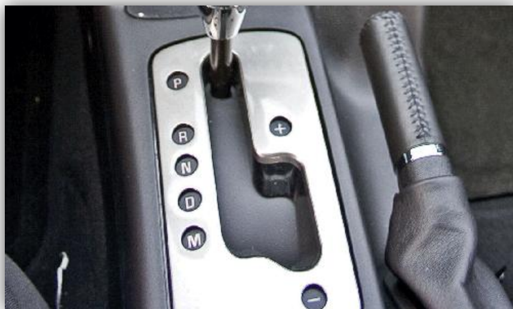
Figura 3.18 Palanca y pistas de selección de modo del Sistema TipTronic
