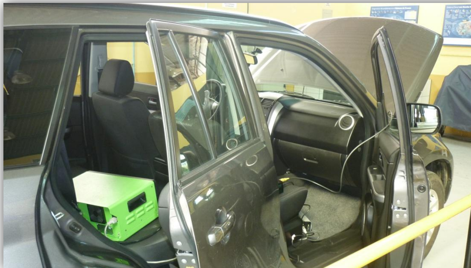
Figura A5.10 Conexión de analizador de gases de escape en el vehículo de transmisión automática
