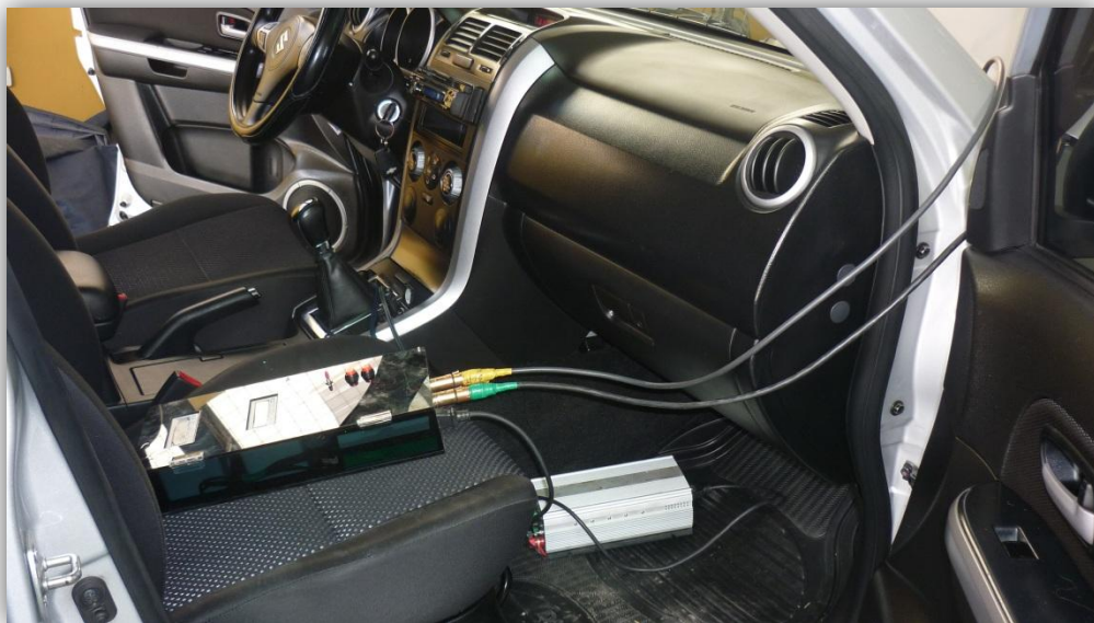
Figura A5.4 Conexión de receptor de medidores de flujo de combustible y convertidor de corriente en el vehículo de transmisión manual.
