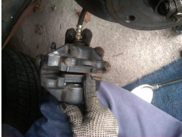
FIGURA N° 12. Montaje de pastillas
