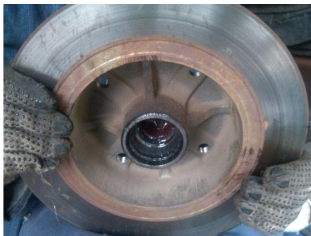
FIGURA N° 10. Disco de freno engrasado
