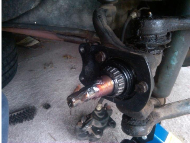
FIGURA N° 9. Punta de eje y rodamiento
