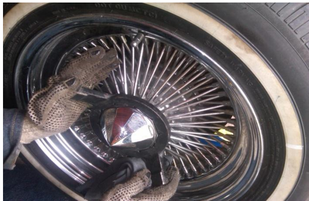
FIGURA N° 31. Ajuste de la tuerca única central
