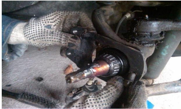
FIGURA N° 14. Ubicación de placa adaptadora delantera
