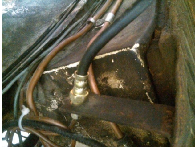
FIGURA N° 14. Redireccionamiento de cañerías
