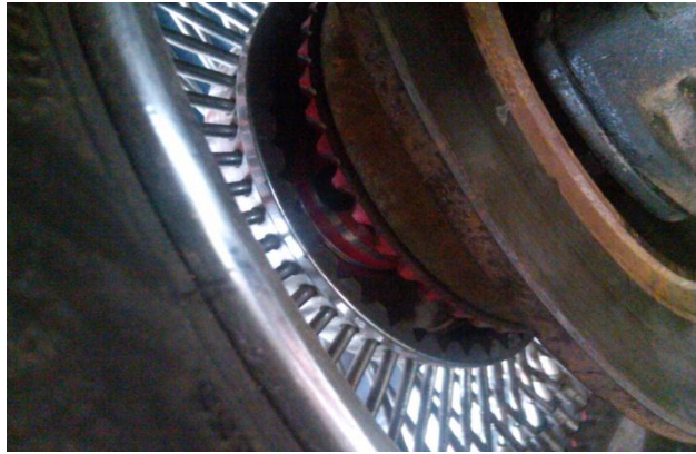
FIGURA N° 30. Acople engranaje de aro
