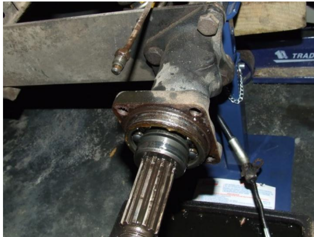
FIGURA N° 6. Limpieza de punta de eje
