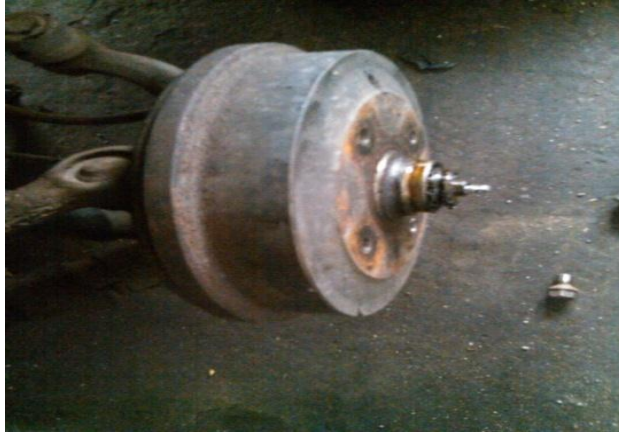
FIGURA N° 7. Final del eje estriado y tuerca
