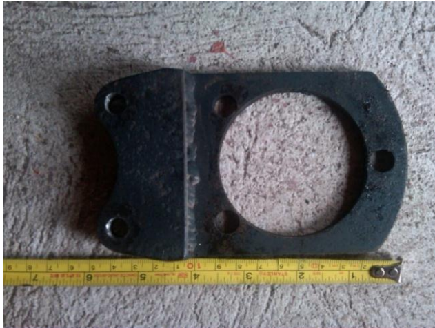
FIGURA N° 11. Medida de placa adaptadora
