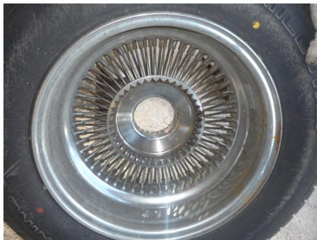
FIGURA N° 17. Aro con engranaje y tuerca central
