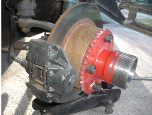
FIGURA N° 16. Sistema de freno completo delantero
