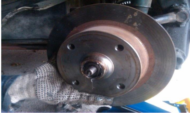
FIGURA N° 20. Desplazamiento de disco
