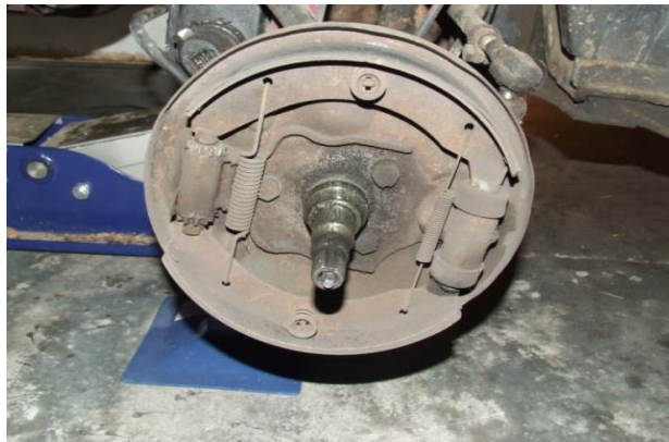
FIGURA N° 8. Parte interna del conjunto tambor
