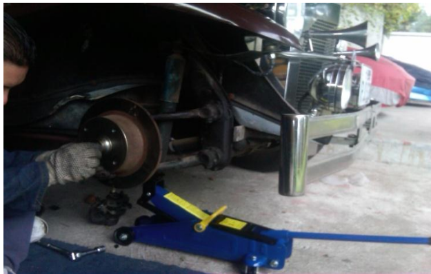
FIGURA N° 19. Engrasando la punta
