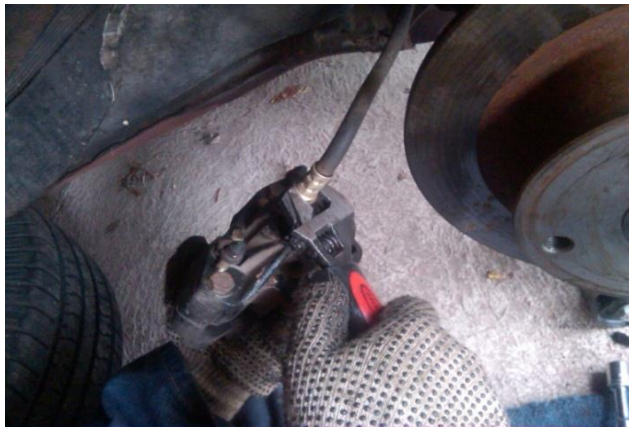
FIGURA N° 21. Ajuste de cañerías a mordaza
