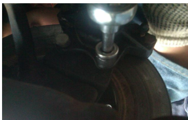
FIGURA N° 25. Ajuste mordaza a la placa adaptadora
