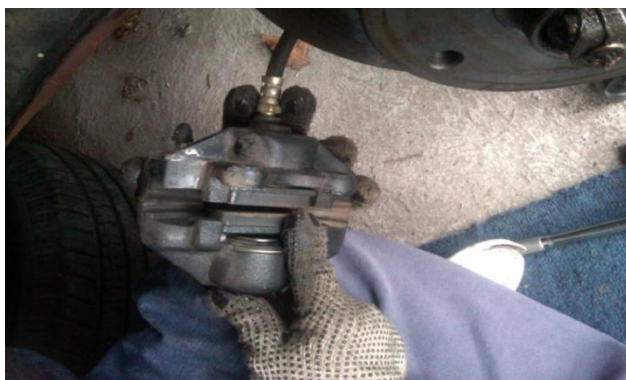
FIGURA N° 22. Colocación de pastillas
