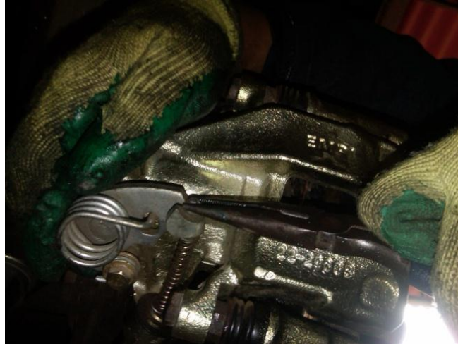
FIGURA N° 21. Colocación del cable freno de mano
