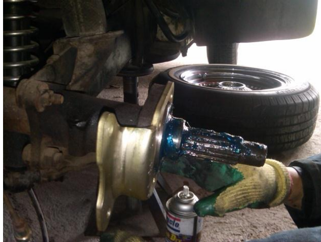
FIGURA N° 18. Placa adaptadora posterior
