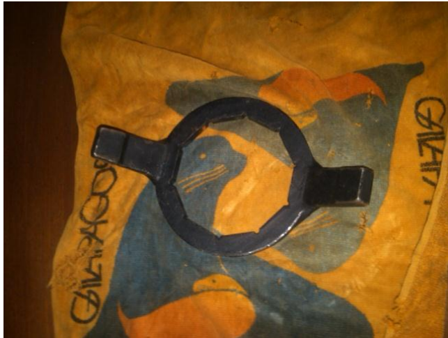
FIGURA N° 22. Llave hexagonal 52 mm
