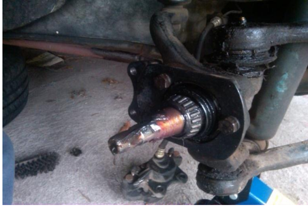
FIGURA N° 16. Engrasado de la punta de eje
