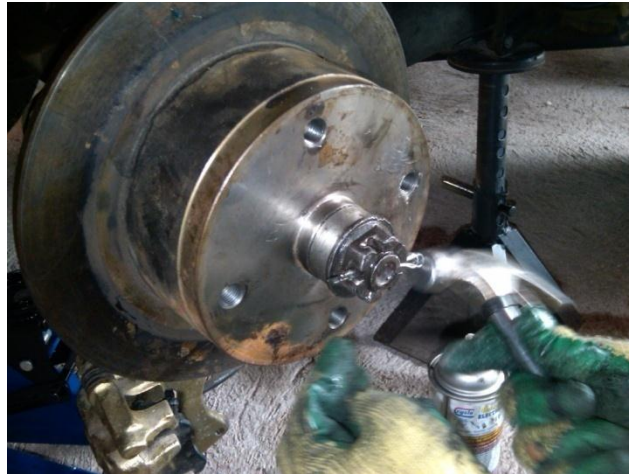
FIGURA N° 20. Seguro tuerca de sujeción
