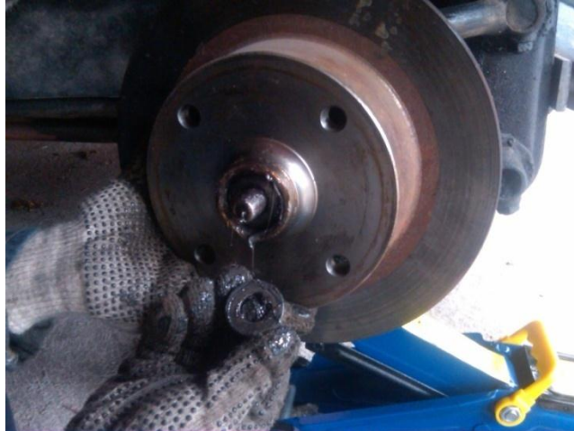
FIGURA N° 11. Disco de freno montado
