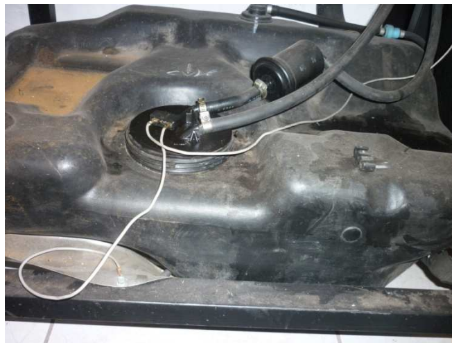
Figura 44. Montaje de la bomba combustible.
