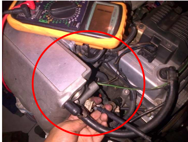
Figura 48. Verificación del cableado de los inyectores.
