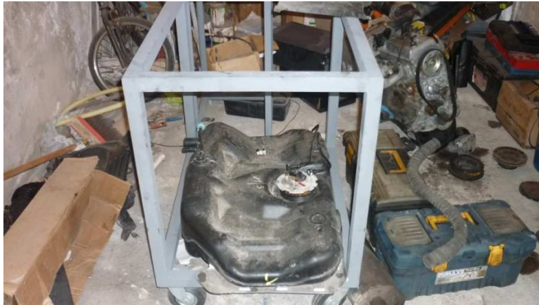
Figura 43. Montaje del tanque de combustible.
