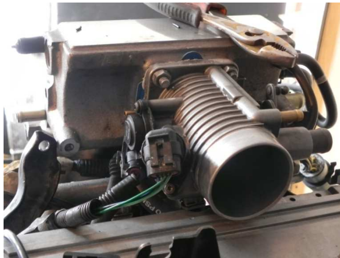
Figura 53. Cuerpo de aceleración Chevrolet Corsa montado en la admisión del motor MAZDA 323.
