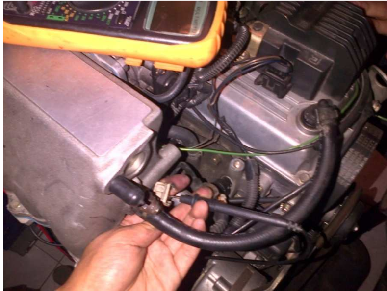
Figura 4. Comprobación de sensores.
