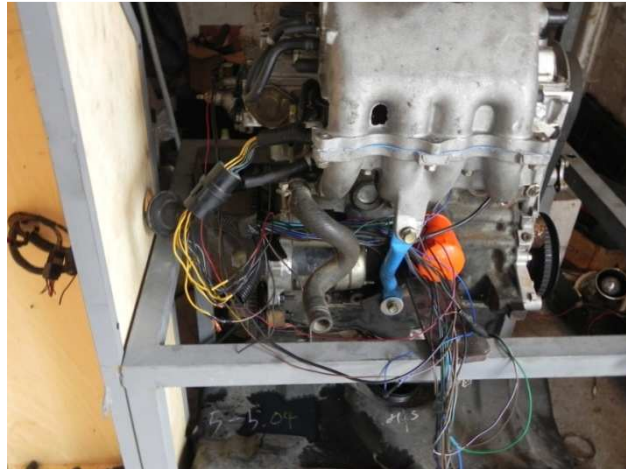
Figura 42. Verificación del cableado principal.
