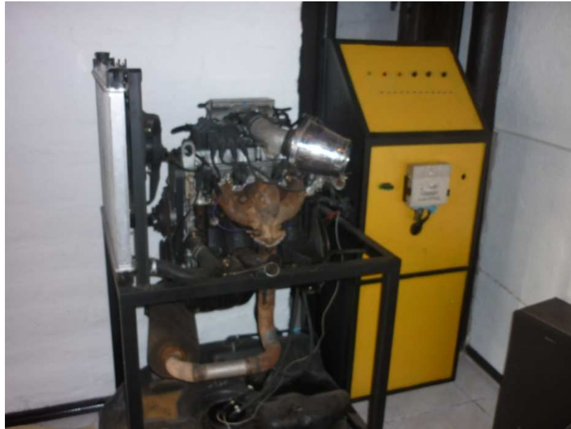
Figura 30. Estructura del motor y su tablero de diagnóstico.
