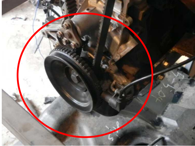
Figura 38. Adaptación de polea dentada de Chevrolet Corsa.
