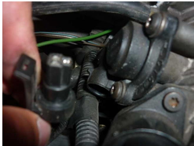
Figura 55. Verificación del sensor TPS.
