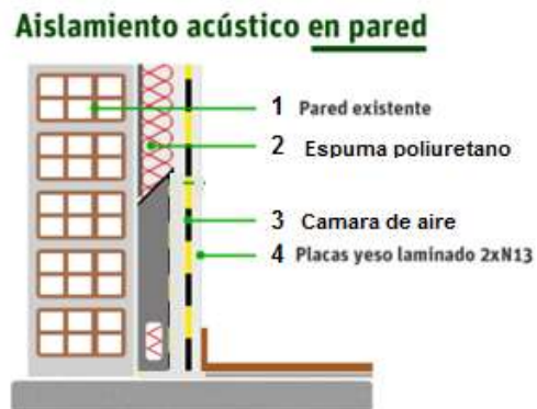
Imagen No. 4 AISLAMIENTO ACÚSTICO EN PARED
