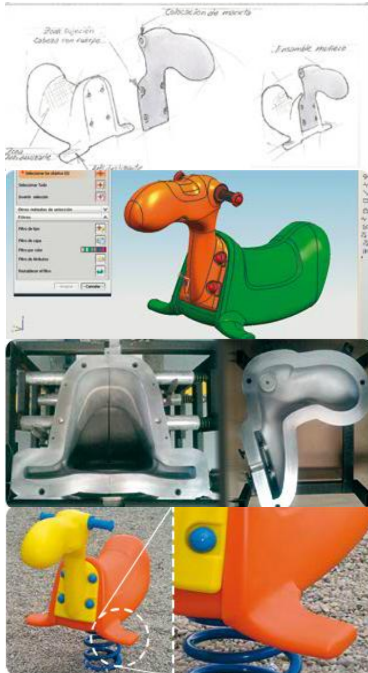
Imagen No. 18 Ejemplo de Molde de rotomoldeo Fuente: www.prodescom.net/empresa.html
