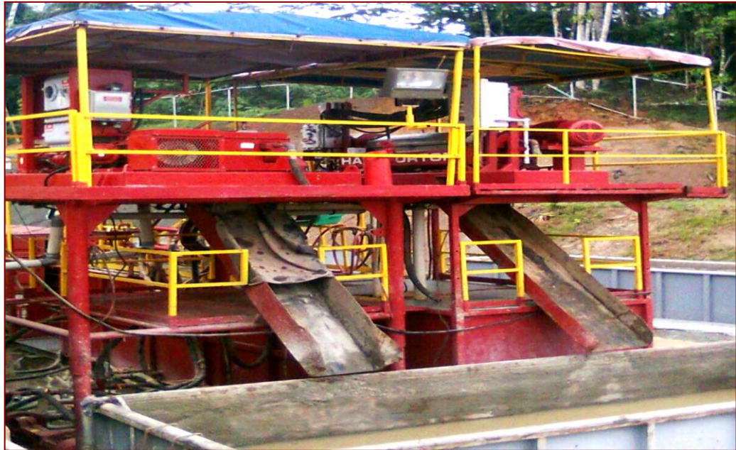
Gráfico 12. Control de Sólidos. Unidad de dewatering y sistema de centrifugas. (Halliburton - Fluids System, 2013)
