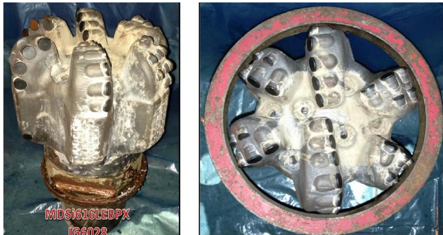
Gráfico 3. Broca PDC (Compactos de Diamante Policristalinos). (Repsol Ecuador, 2014)
