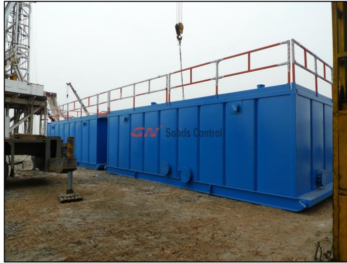
Gráfico 48. Tanque de almacenamiento para CRI.
