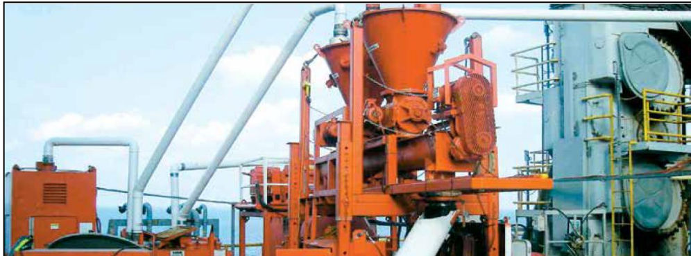
Gráfico 44. Sistema de vacío de descarga continua de la tolva de vacío. (M-I SWACO, 2014)
