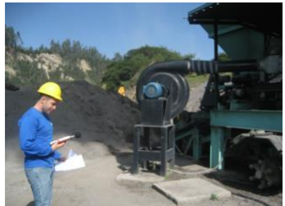
Monitoreo ruido ambiental en generadores
