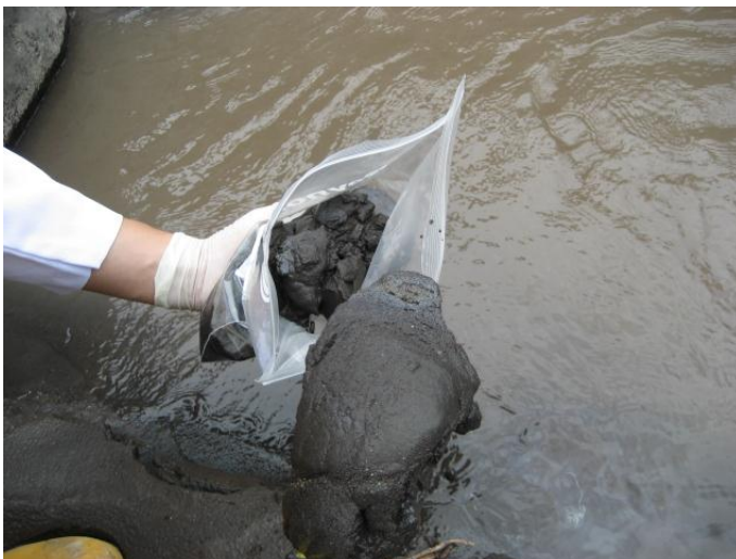
Conservación, y empaque de la muestra obtenida en el sedimento del suelo del río Pita, en el punto crítico de la contaminación donde operan las concesiones mineras
