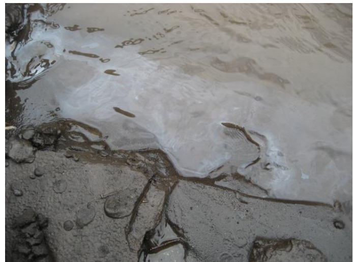
Deposición de Hidrocarburos Totales de Petróleo en sedimento, en el punto crítico de la contaminación, donde las concesiones mineras hacen lavado de material en el río Pita
