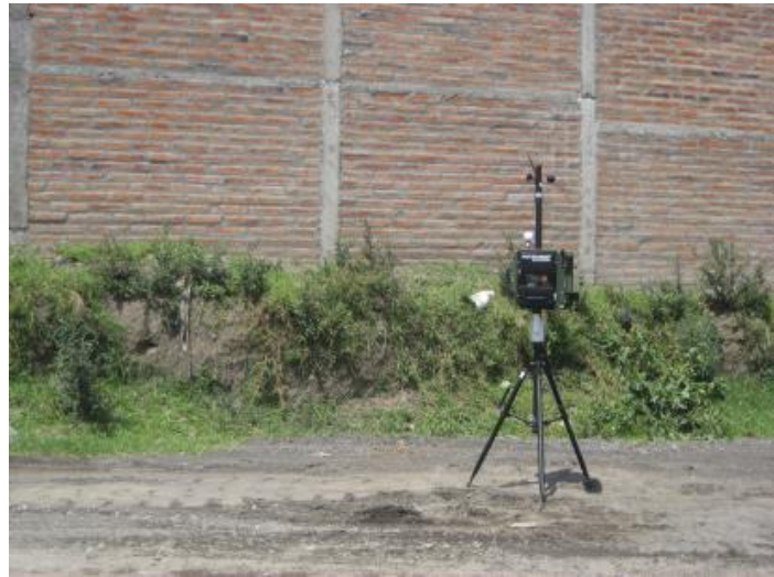
Ubicación del Equipo Haz Scanner Epas para ensayo de calidad de aire, en el punto crítico de la contaminación donde operan las concesiones mineras
