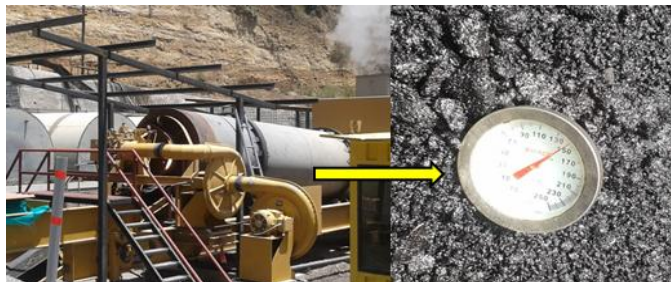
Figura 44. Temperatura de operación para la refinación del asfalto
