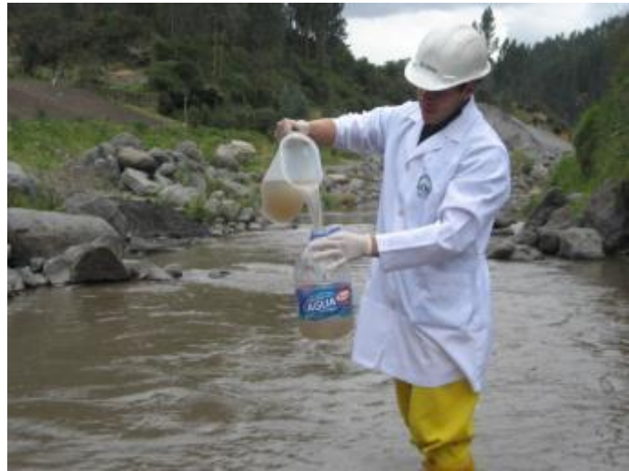
Trasvase de la muestra al recipiente de recolección en el punto crítico de la contaminación
