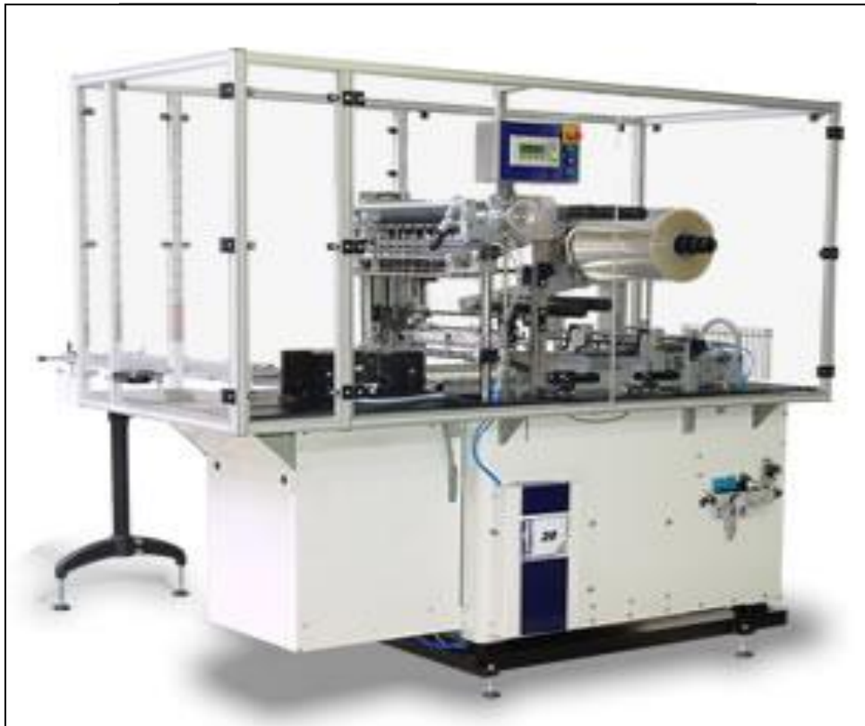
Gráfico 3.28 Empacadora para sobre envoltura de Té hoja de higo. SOLLAS 20
