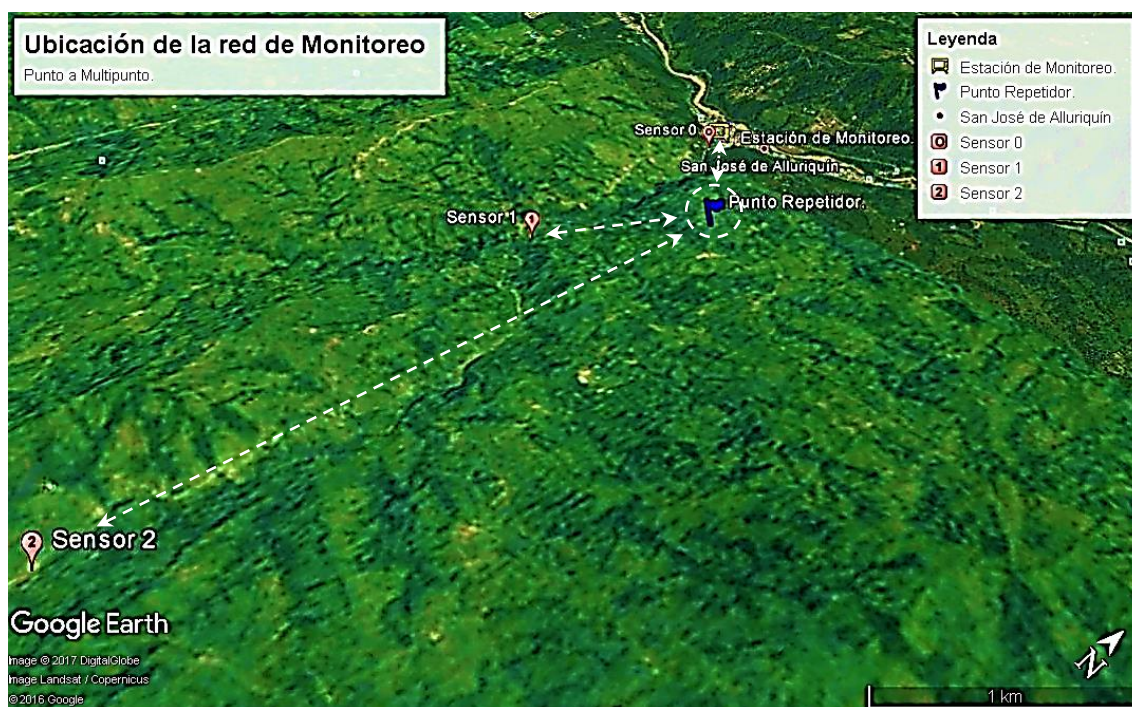
Figura 31. Diseño de la red punto a multipunto del SAT del proyecto.
