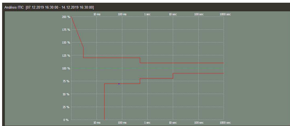
Figura 33. Curva ITIC de Laboratorio.
