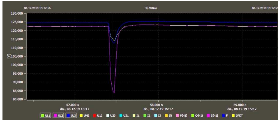
Figura 31. Hueco de voltaje en Laboratorio
