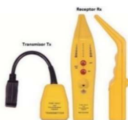
Figura 10. Identificador de circuitos (Test Equipment, 2016)
