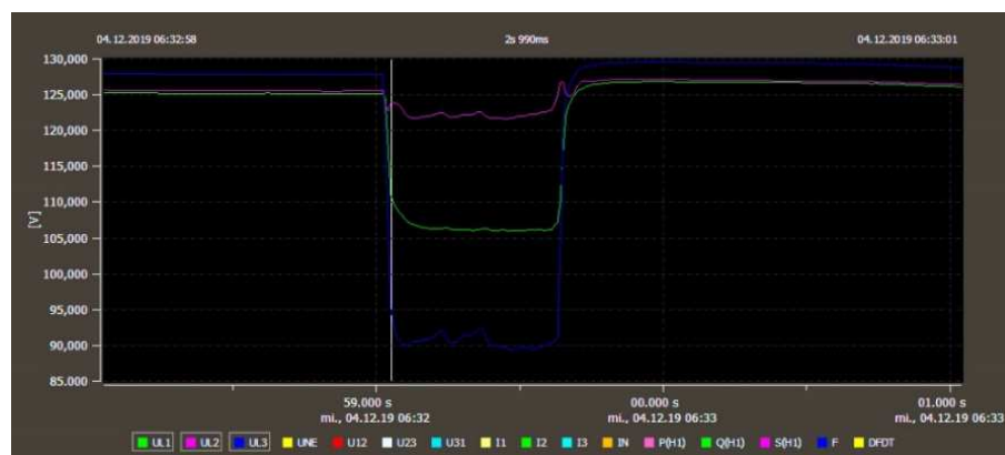
Figura 43. Hueco de voltaje en TIC.
