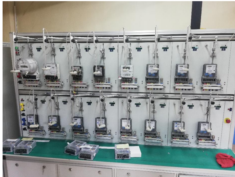
Figura 41. Mesa de pruebas de Contrastación para medidores de energía
