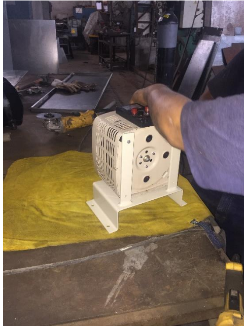
Figura 20. Montaje del variac.
