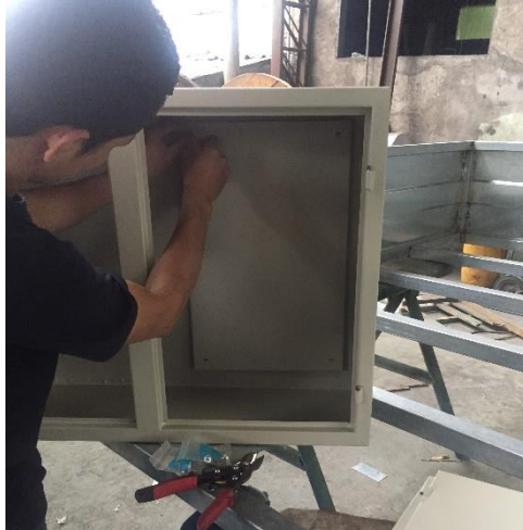
Figura 18. Doble fondo del gabinete metálico.
