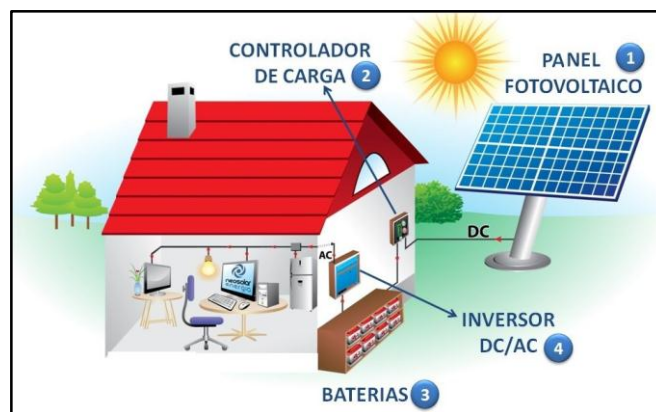
Figura 2 Uso electricidad fotovoltaica (José Palomero, 2014)
