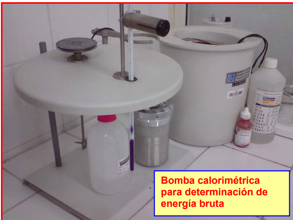
Fotografía 15 – Bomba calorimétrica para determinación de energía bruta
