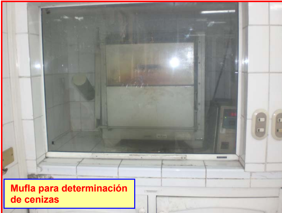
Fotografía 24 – Mufla para determinación de cenizas
