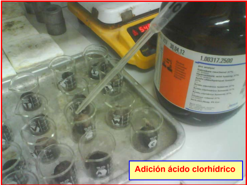
Fotografía 18 – Adición ácido clorhídrico
