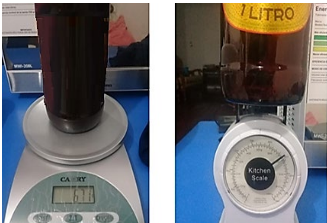
Figura 14. Toma de datos mediante balanza CAMRY de la botella de un litro de la marca pilsener con una masa de 671 gr, su transformación es 6.71 Kg parte izquierda, y a la derecha se observa una Kitchen Scale con un valor alrededor de 671 gr aproximadamente.
