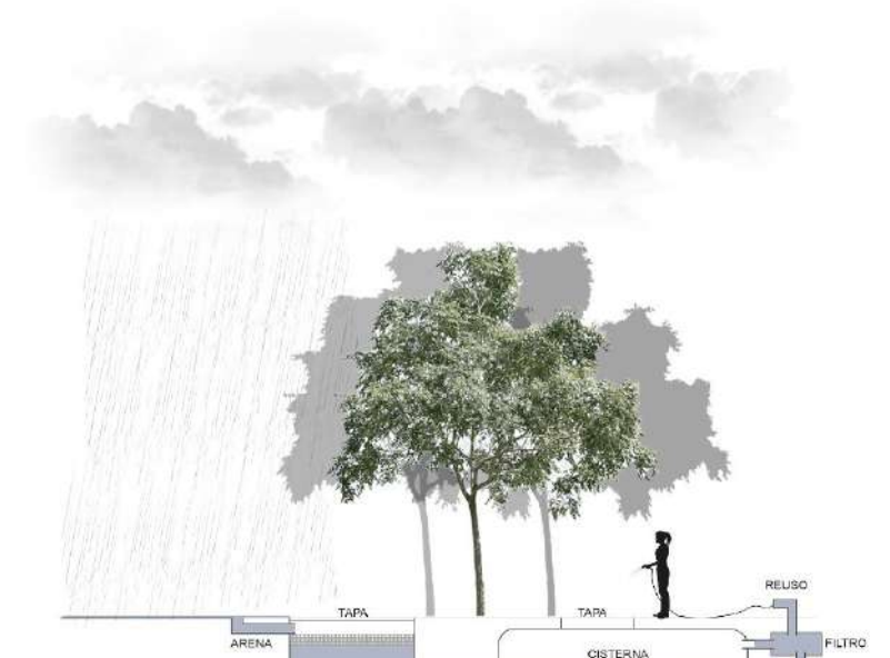
Figura 20: Esquema de recolección de aguas lluvia.
