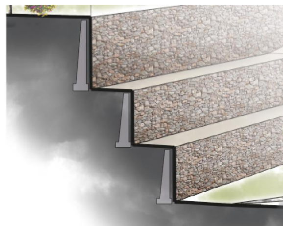
IMAGEN 18. Muros de contención
