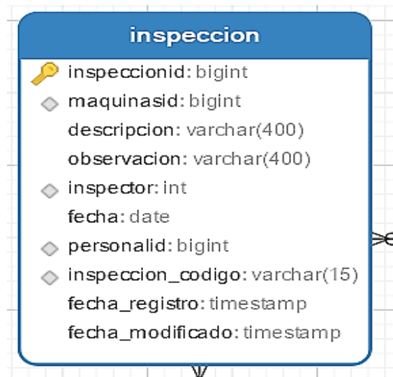
Figura 18. Tabla de inspección
