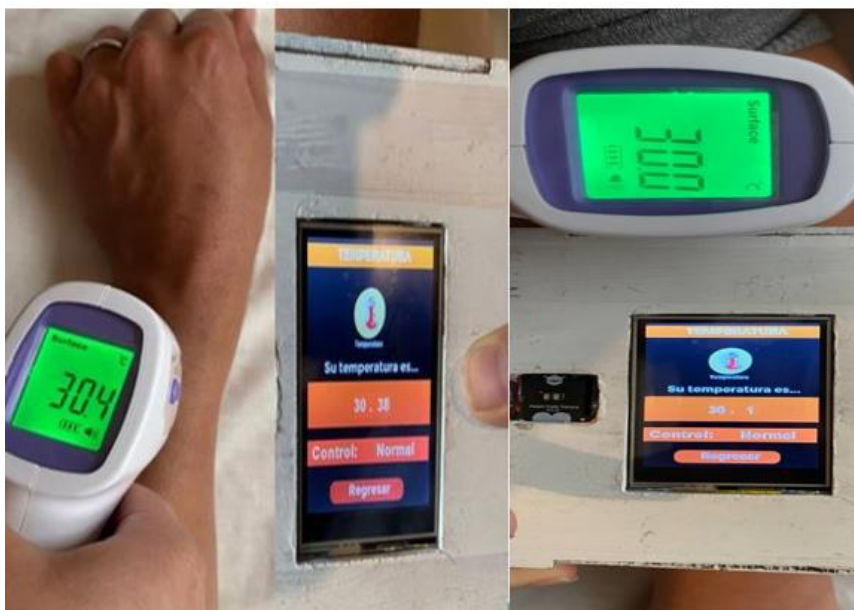
Figura 24. Temperatura en la muñeca de sujeto 1 y sujeto 2
