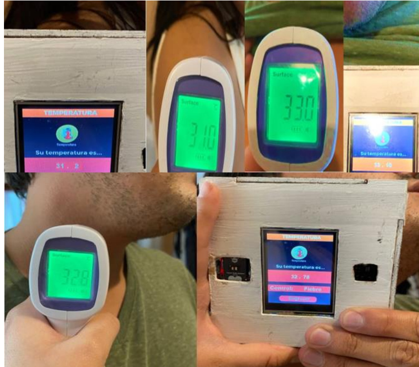
Figura 23. Medidas de temperatura en distintas partes del cuerpo para sujeto 1 y sujeto 2
