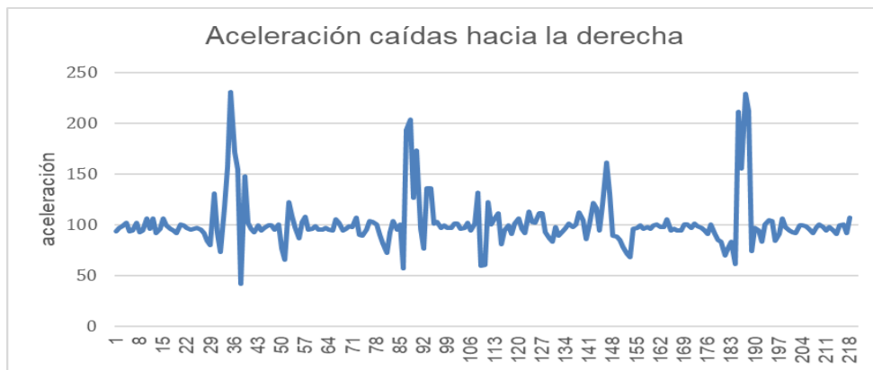
Figura 40. Aceleración total de caídas hacia la derecha
