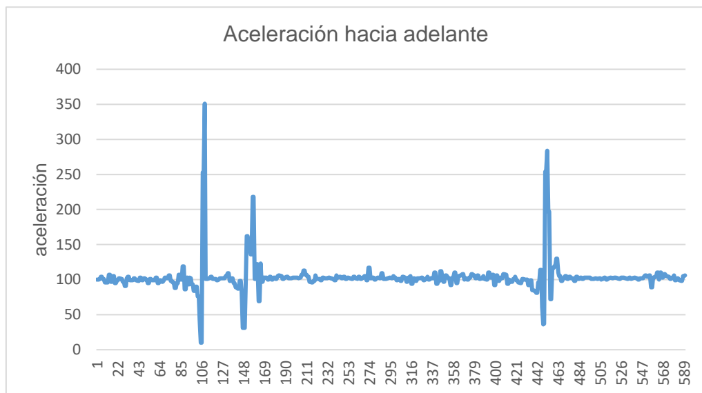
Figura 44. Aceleración total en caídas hacia adelante
