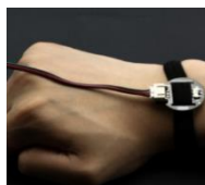
Figura 10. Sensor SEN203 DFROBOT colocado en el dorso de la muñeca (DFROBOT, 2013)
