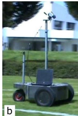
Figura 2. Robot móvil diferencial autónomo y tele-operado (Velázquez et al., 2020)
