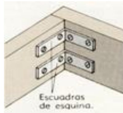
Figura 2-65. Ensamble en L con tacos triangulares. Figura 2-66. Ensamble en L con escuadras de esquinas.
