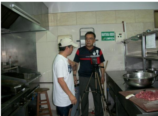
Fotografía 4.4 : Medición del índice WBGT Fuente: Bolívar Haro Haro
