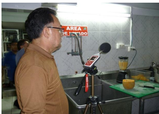
Fotografía 4.1: Mediciones de ruido en las instalaciones de la cocina Fuente: Bolívar Haro Haro
