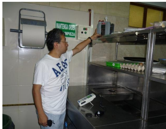
Fotografía 4.3 : Mediciones de material particulado, CO2 y CO en restaurante y cocina Fuente: Bolívar Haro Haro
