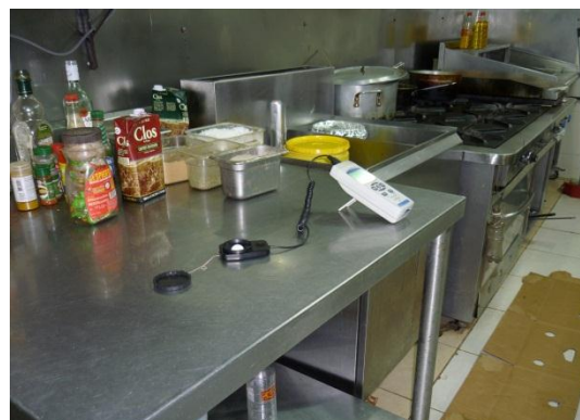
Fotografía 4.2 : Mediciones de iluminación en las instalaciones de la cocina Fuente: Bolívar Haro Haro
