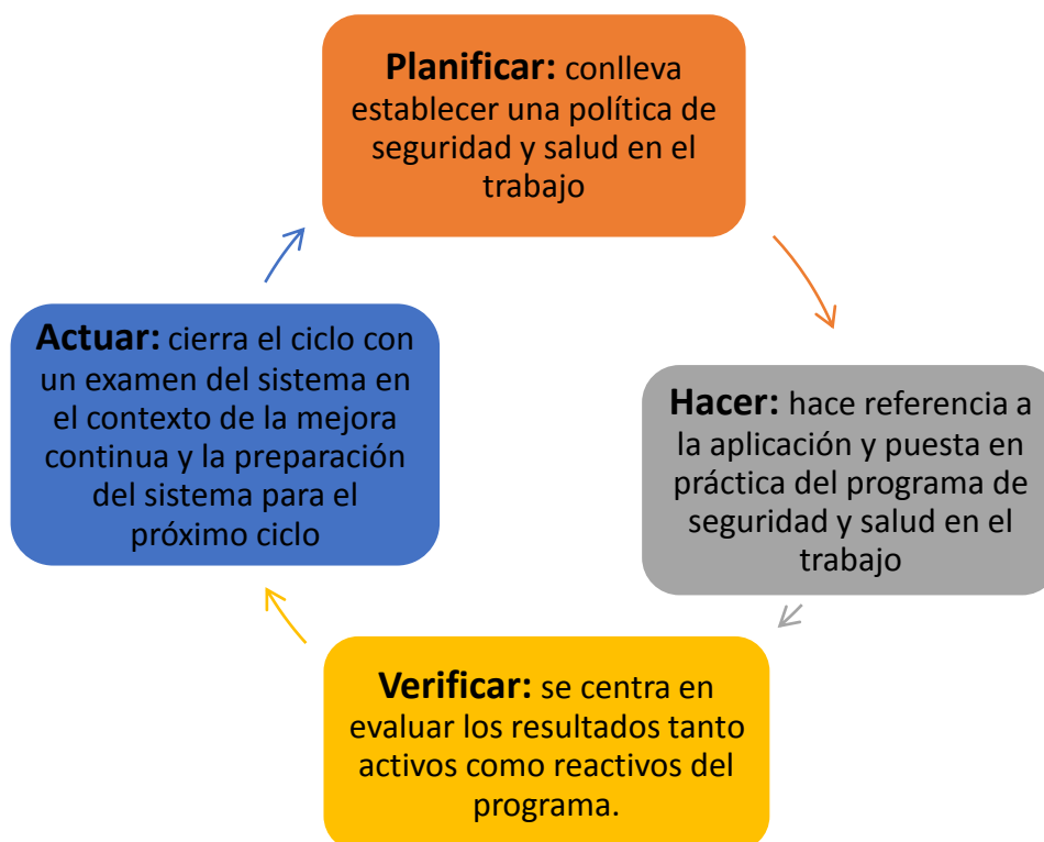
Ilustración 1. Componentes de un Sistema de Gestión de Seguridad y Salud en el Trabajo “Círculo Deming”
