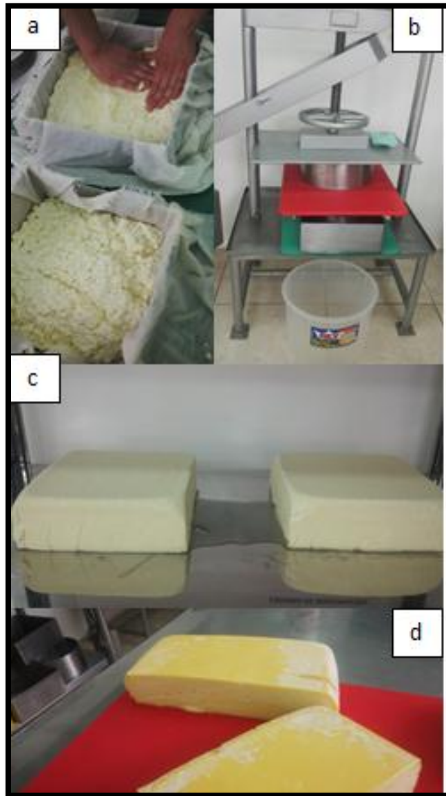
Figura 8. Moldeo, prensado y madurado del queso (a) Moldeo, (b) Prensado, (c) colocación cámara de maduración (d) Queso maduro
