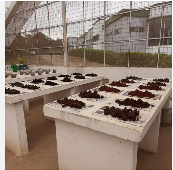
Secado de suelo contaminado.
