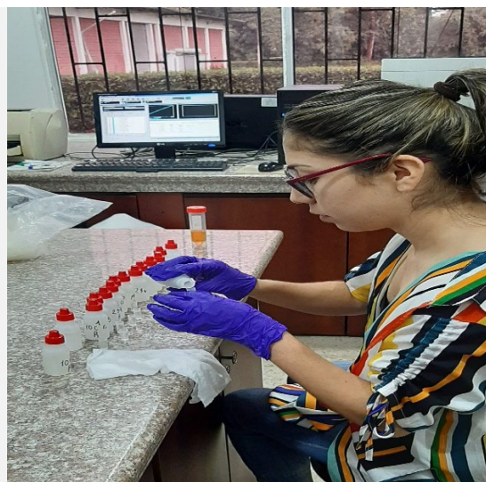
Preparación de muestras para lectura en el horno de grafito.
