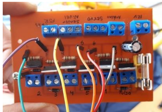
Figura 24. Placa PCB con sus componentes soldados.
