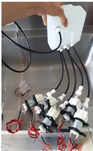
Figura 16. Toma independiente del reservorio para cada bomba.
