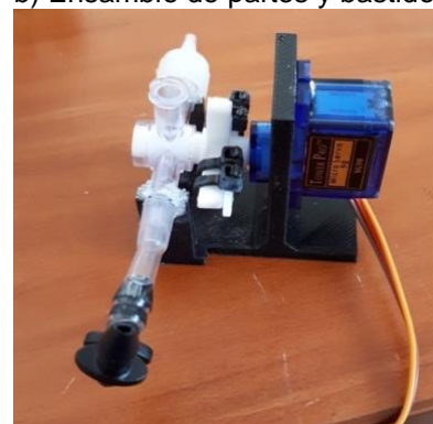
Figura 8. Bastidor para válvula de 3 vías y servomotor
