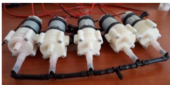
Figura 15. Toma individual desde el reservorio para todas las bombas
