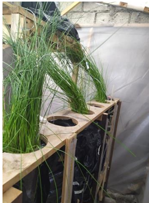
Figura 14. Biofiltros de tipología LP: medio filtrante, macrófitas y lombrices.
