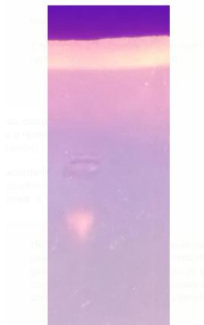
Figura 20. Visualización en gel agarosa 1,2% de amplicones. Fragmentos de aproximadamente 300 pb amplificados con primers 16S F y R.
