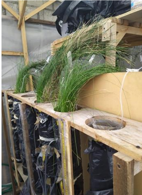
Figura 13. Biofiltros de tipología P: medio filtrante y macrófitas
