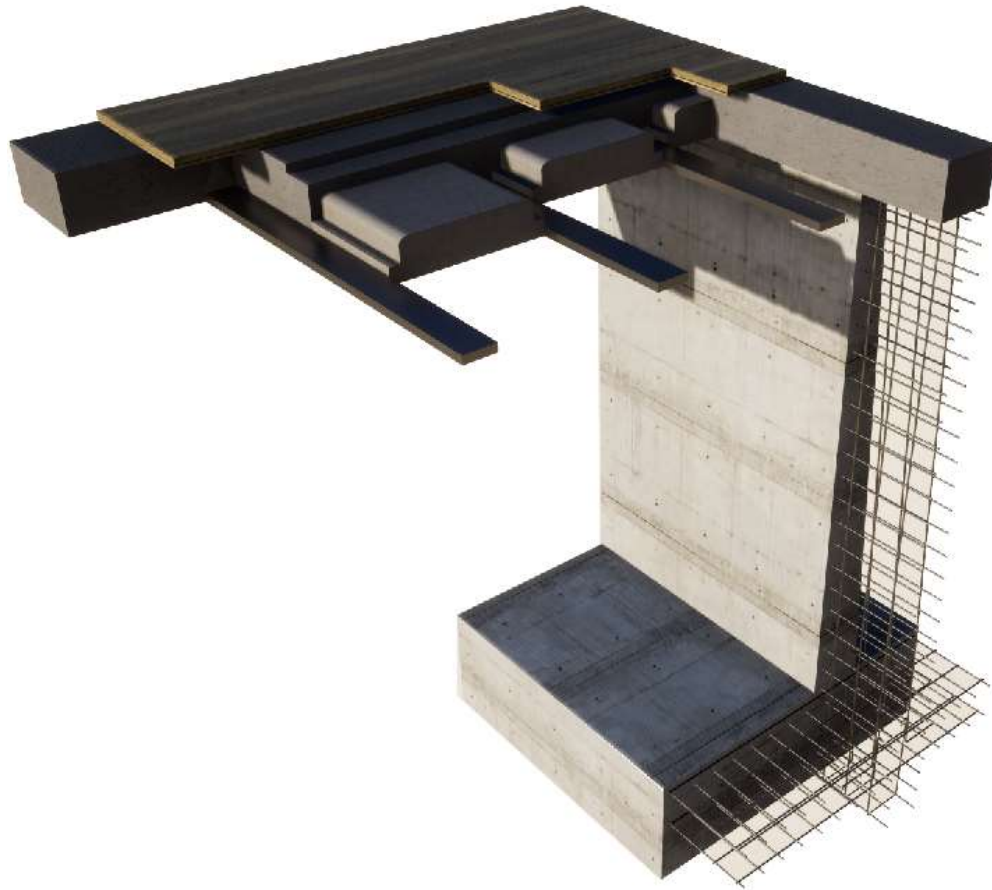
Ilustración 68: Sistema estructural diafragma Elaboración: Propia
