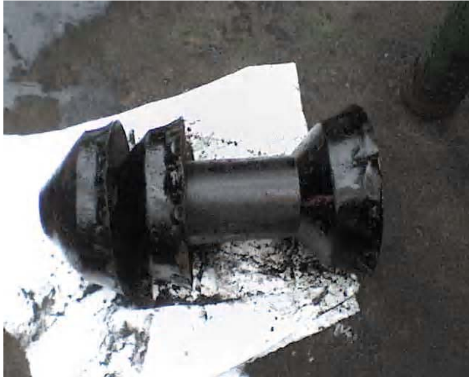
Foto 09. Estado del Raspatubos después del Marraneo
