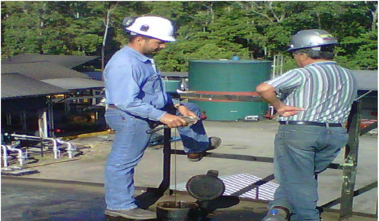
Figura 3.54 – Medición del Nivel del Colchón de Agua (Tanque de Lavado)
