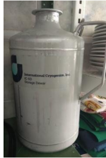
Figura 66. Tanque criogénico para nitrógeno líquido
