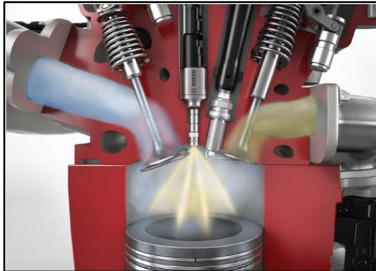
Figura 4. Ubicación de los inyectores. (Gil, 2002)
