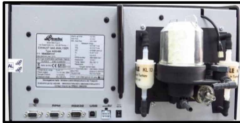
Figura 16. Conexión de dispositivos. Conectar cables de datos del analizador hacia el ordenador o computador.
