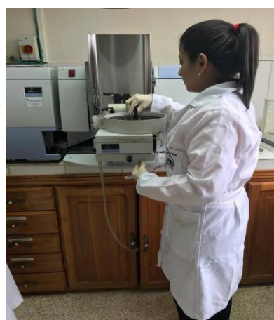
Cuantificación de Cd en muestras de tejidos digeridas en el espectrofotómetro de absorción atómica
