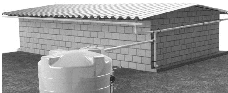
Fig. 15. Ejemplo de captación de agua de lluvia de techos
