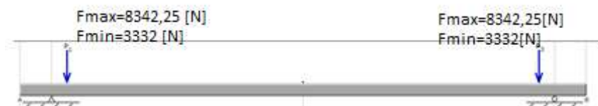
Figura 6. Diagrama de fuerzas en la viga
