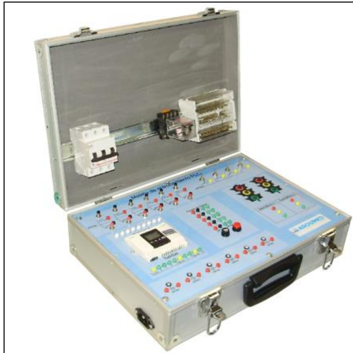
Figura 3. Simulador para entrenamiento en electrónica (Rusia Patente nº RU0002636020, 2016)
