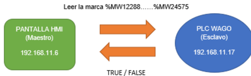
Figura 23. Bloque de comunicación Modbus TCP
