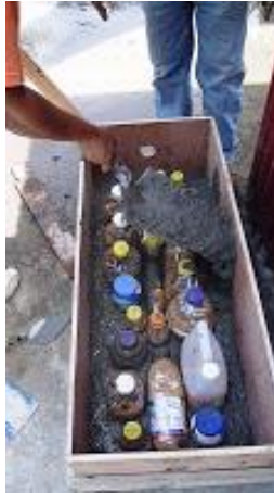
Fig. 29. Encapsulamiento de baterías (López M, 2016).
