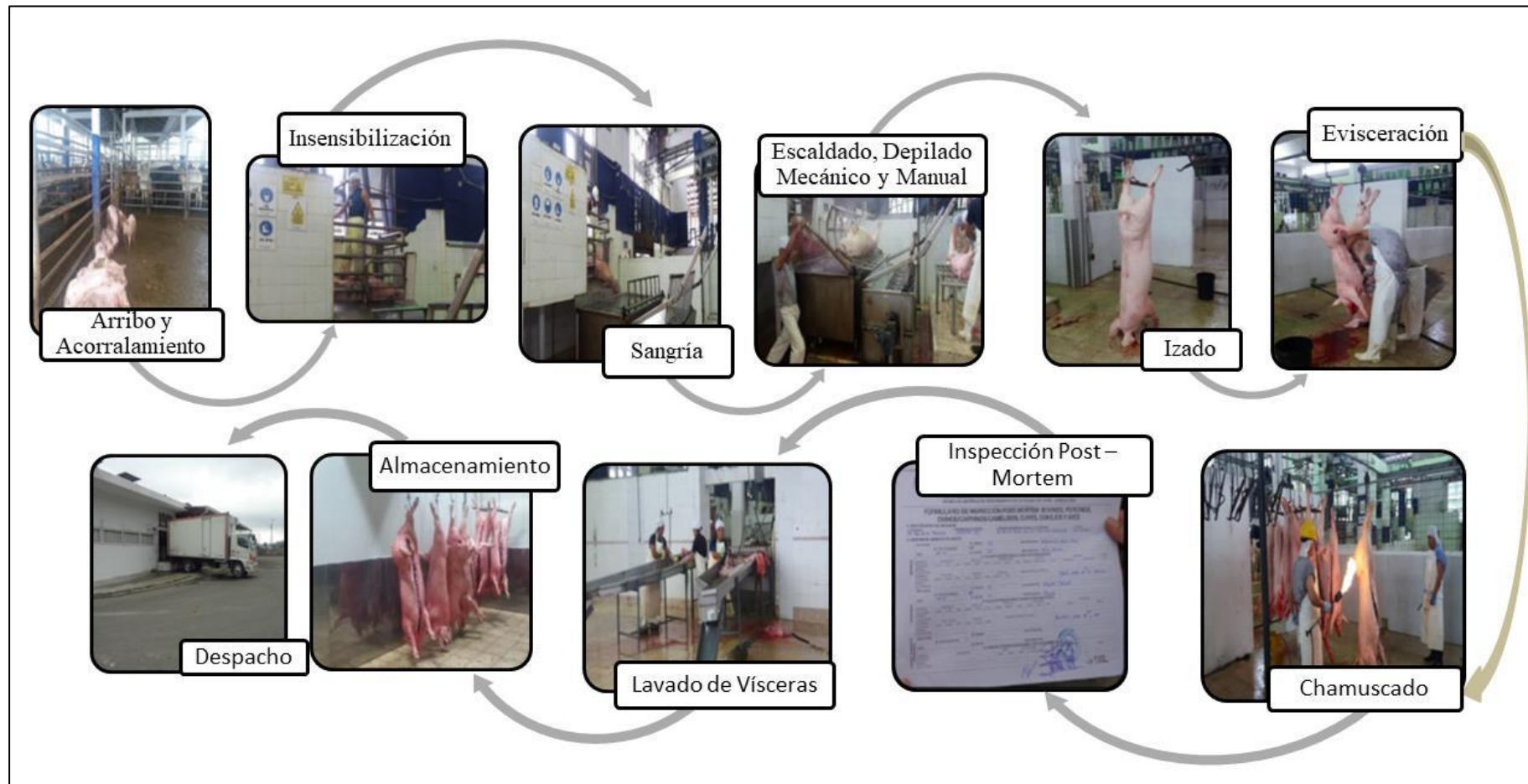
Figura 2. Diagrama de proceso para el faenamiento de ganado porcino
